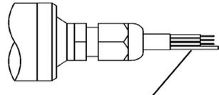
Bei **Kabelauführung**: Referenzluft-Zufuhr nicht verschließen! Vor Feuchtigkeit schützen!
